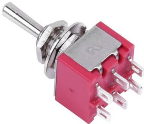
Mini 6Pin (OP)-OFF-(OP) DPDT 3 Posities Tuimelschakelaar MTS-223 Dual Reset Schakelaar AC 250 V 2A/AC 5A 120 V
